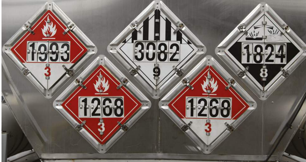
Figura 10-16 O painel de segurança é um sinal em formato de losango fixado a um veículo de transporte de produtos controlados/perigosos.
